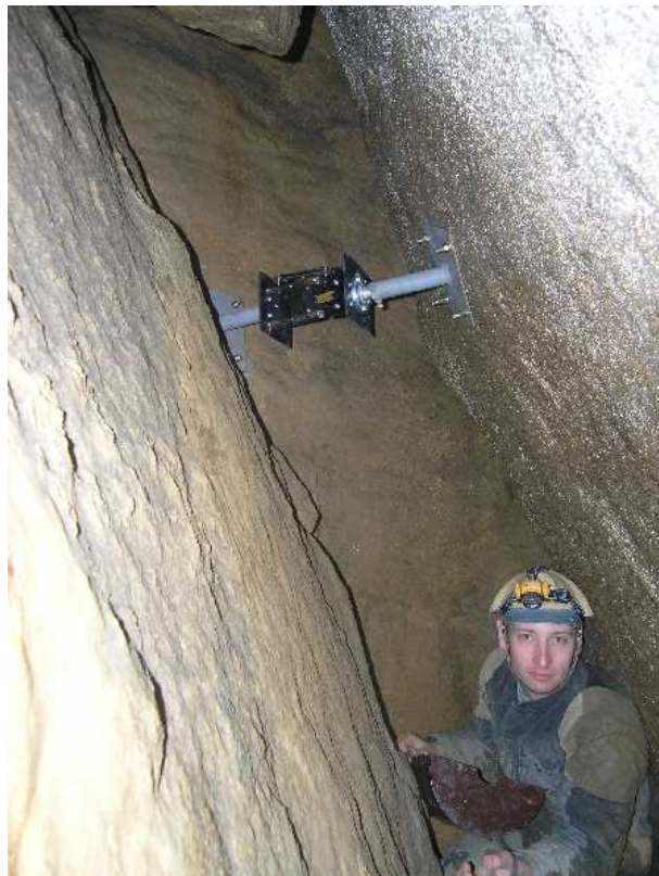
Obr. 1 Přístroj TM-71 v jeskyni Pod Kazatelnou I
