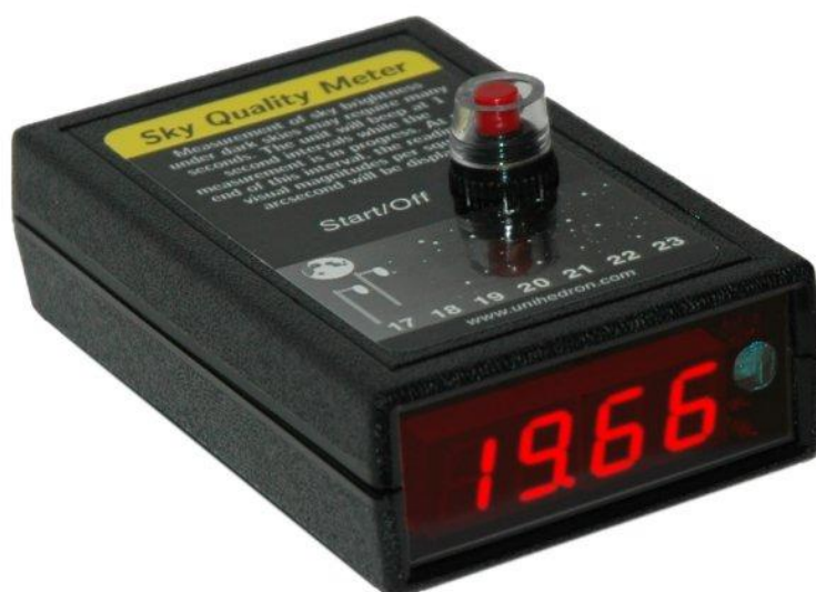
Obr. 2 Sky Quality Meter (zdroj: Unihedron 2013)
