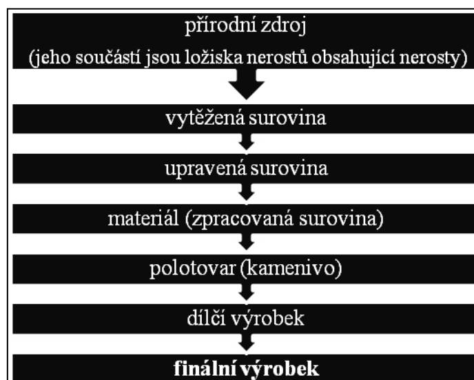
Obr. 2: Postup výroby z přírodního zdroje (Zdroj: Sivek, M., 2007, upraveno)
