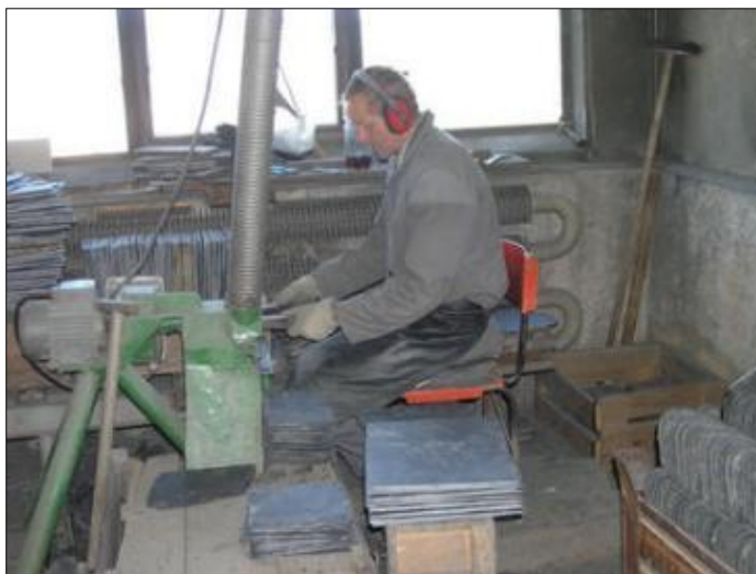
Obr. 36: Zpracování břidlice, rok 2006 - strojní formátování našťípaných desek na požadovaný tvar (Foto: M. Vavro, 2006)
