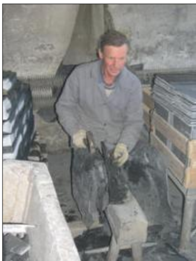
Obr. 35: Zpracování břidlice, rok 2006 - štípání pokrývačské břidlice na tenké desky (Foto: M. Vavro, 2006)
