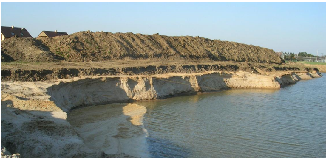
Obr. 2: Vrstva štěrkopísků v dobývacím prostoru Velký Osek I (foto: J. Braun, duben 2013)
