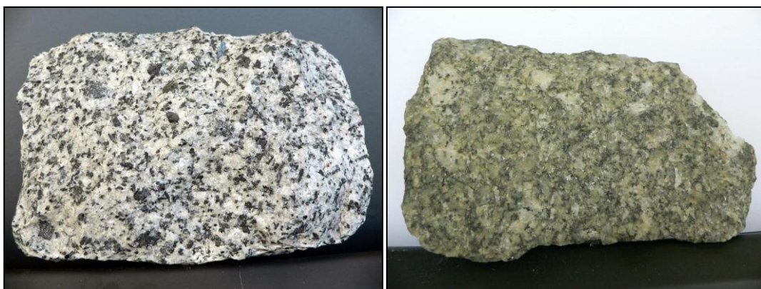
Obr. 48: Porovnání hornin Granodiorit a mylonit (Katedra geotechniky Stavební fakulty ČVUT, 2006)
