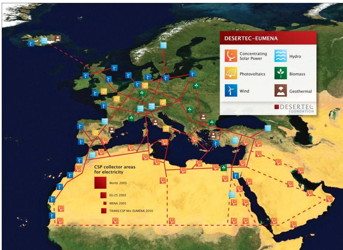
Obr. 9 Schéma projektu Desertec. Velký červený čtverec na Saahaře představuje oblast, která má pokrýt spotřebu elektřiny celého světa (World 2005), menší čtverce pak ukazují plochu, která může elektřinou zásobovat celou Evropu (EU-25 2005), respektive Spolkovou republiku Německu (MENA 2005).
