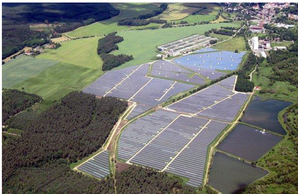
Obr. 2 Největší fotovoltaická elektrárna v České republice postavená poblíž města Ralsko s výkonem 38,3 MW.
