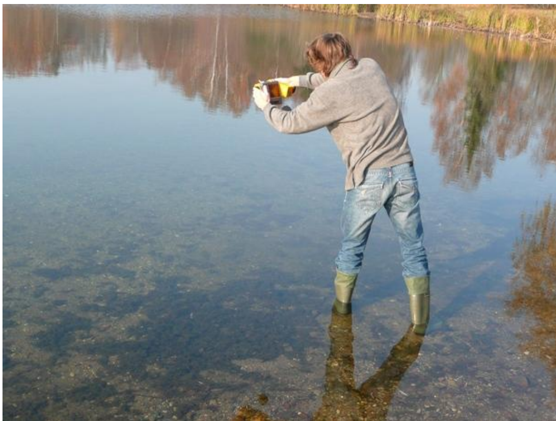
Obr. 2: Měření povrchové teploty vody ruční termální kamerou (foto: M. Vysoudil, 2012)
