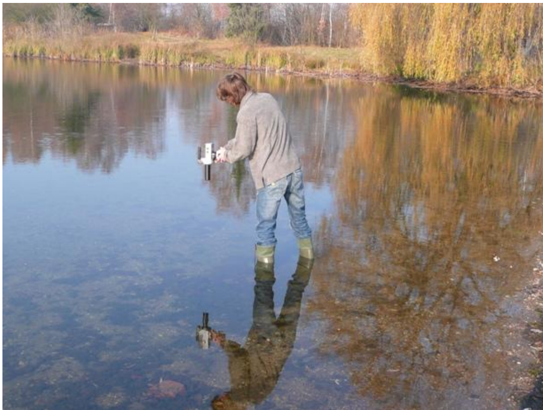
Obr. 1: Měření emisivity vodní hladiny pyrometrem (foto: M. Vysoudil, 2012)
