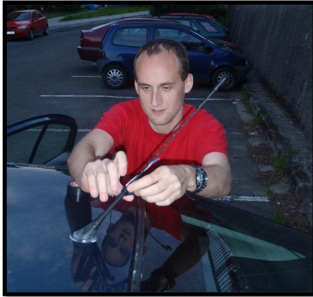
Obr. 3 Instalace teplotního čidla pro automobilové mobilní měření
