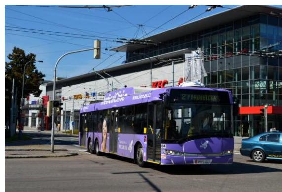
Obr. A. 2 Trolejbusy Škoda vyráběné ve spolupráci s polskou firmou Solaris – na snímku vlevo sólo trolejbus v Teplicích a vpravo třínápravový vůz v Pardubicích (Kameníček, 2011)
