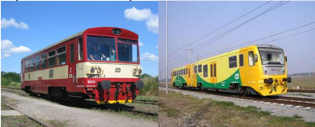
Obr. č. 6 a 7: Motorový vlak řady 810 (vlevo) a jeho zmodernizovaná verze Regionova od společnost Pars nova a.s. v Šumperku
