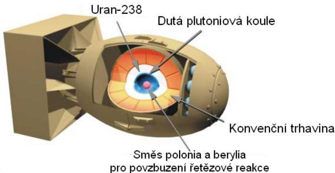
Obr. 2 Implozivní typ jaderné zbraně.
