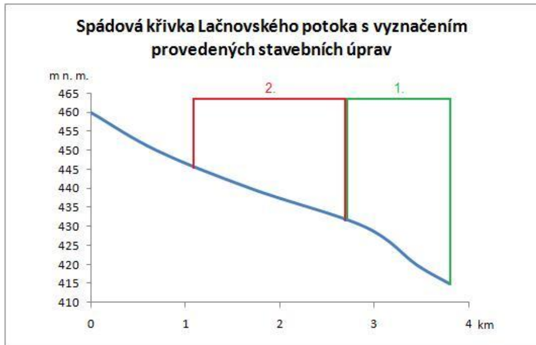
Graf 10: Spádová křivka Lačnovského potoka s vyznačením provedených stavebních úprav z let 2004 až 2009.
