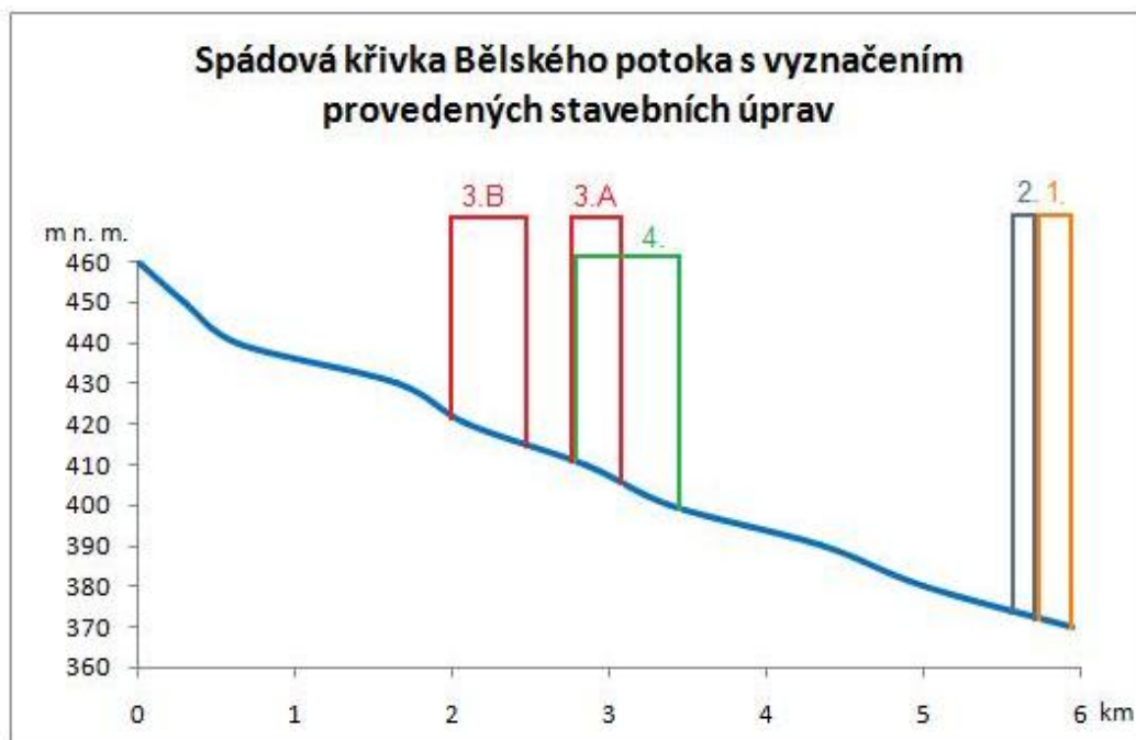
Graf 5: Spádová křivka Bělského potoka s vyznačením provedených stavebních úprav z let 1999 až 2009.
