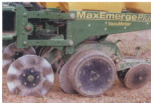
Obr. 6 Stroj na přesné setí kukuřice do mulče vybavený prořezávacími kotouči a dvoukotoučovými secími botkami s omezovači hloubky setí (podle Janečka, 2007)
