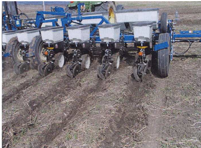
Obr. 7 Setí širokořádkové plodiny bez jarní předseťové přípravy půdy – jízdy ve směru vrstevnic přispívají k ochraně půdy před vodní erozí (podle Janečka, 2007)
