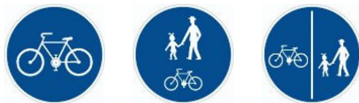
Obr. 4.7: Svislé dopravní značky pro cyklostezku, stezku pro chodce a cyklisty, stezku pro chodce a cyklisty s rozděleným provozem
