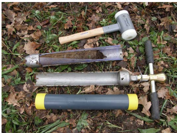
Obr. 15: Nástroje použité k odběru půdních vzorků ze stanoviště v lužním lese (foto: J. Zelinka, duben 2008)
