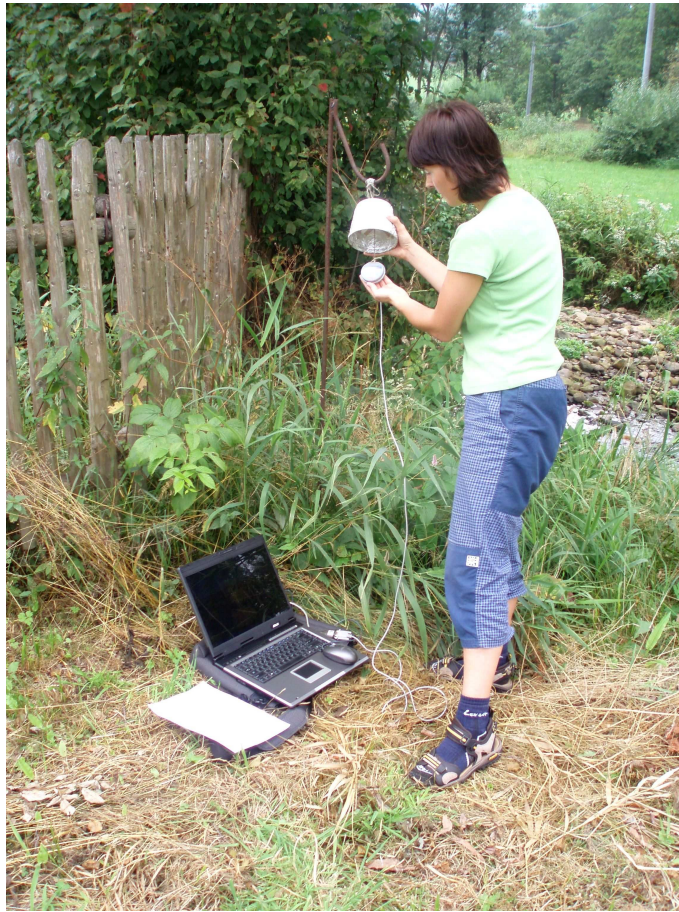
Obr. 5. Průběžné ukládání dat ze sběrnice MicroLog (Havlíčková, srpen 2007)
