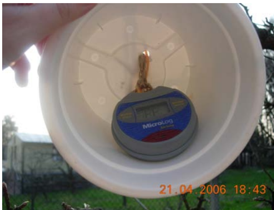
Foto 1. Digitální data logger MicroLog (Pohlodková, duben 2006)
