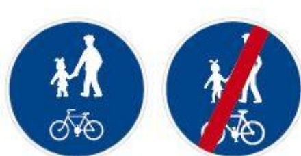
Obr 2. Dopravní značka „Stezka pro chodce a cyklisty“ (č. C 9a) a dopravní značka Konec stezky pro chodce a cyklisty (č. C 9b) (Dopravní značky s komentářem, 2013).
