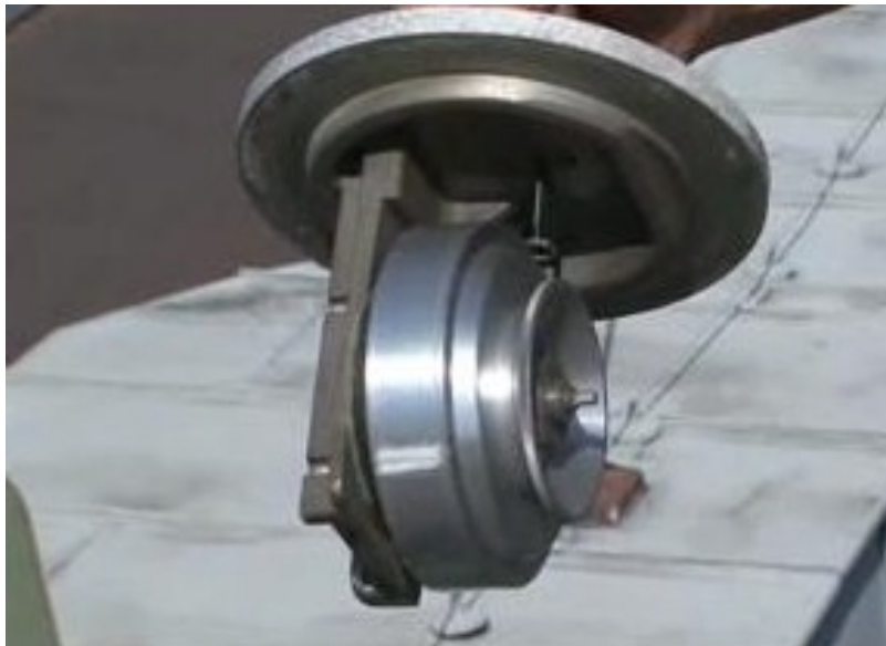
Obr. 8 Vnitřní část pylového volumetrického lapače – bubínek s průhlednou páskou (Zdroj: pylovaslužba.cz, 2013)
