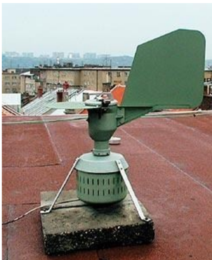
Obr. 6 Pylový volumetrický lapač Burkard, Brno (Zdroj: zdravi.e15.cz, 2007)
