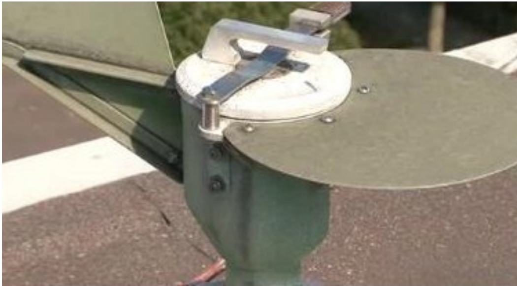
Obr. 7 Vrchní část pylového volumetrického lapače (Zdroj: pylovaslužba.cz, 2013)
