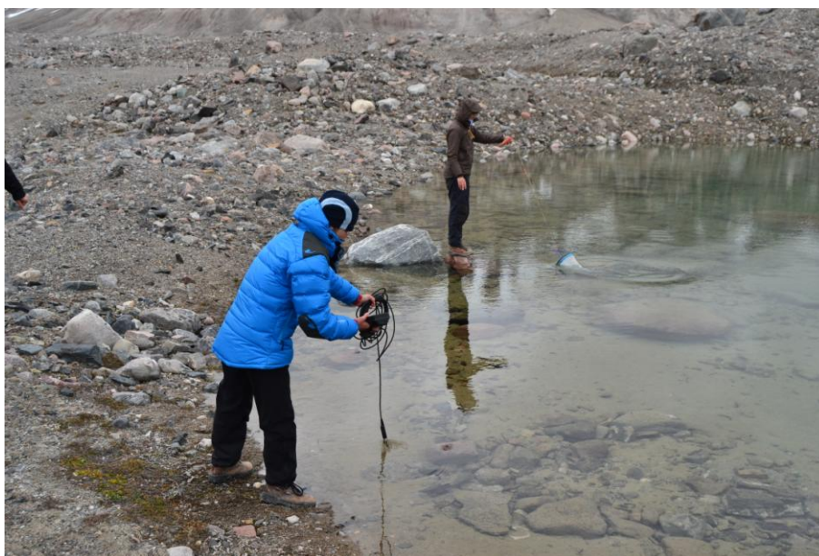
Obr. 4.3.1: Terénní práce s multisondou YSI 556 MPS (autor: Jan Kavan, 2012)
