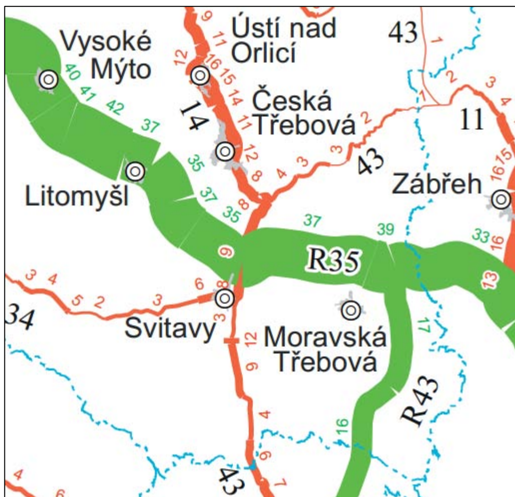
Obr. 8: Prognóza intenzity dopravy na Svitavsku v roce 2040 (výřez z mapy, údaje v tisících vozidel za 24 hodin)
