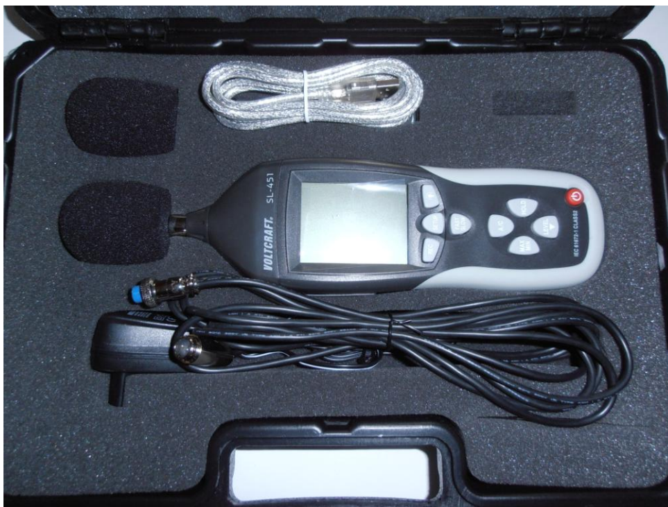
Obr. 1 Hlukoměr firmy Voltcraft (Pešková, 20. 10. 2011)
