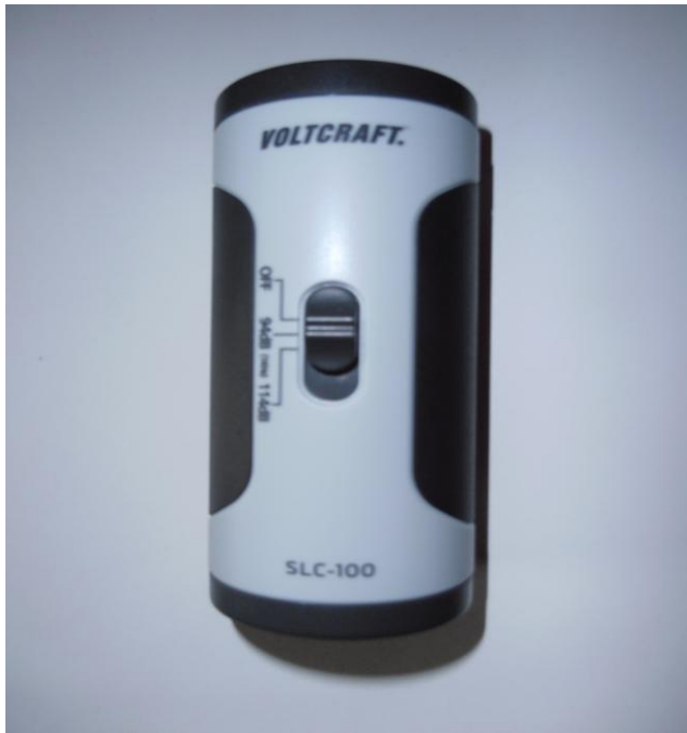
Obr. 2 Kalibrační přístroj firmy Voltcraft (Pešková, 20.10. 2011)
