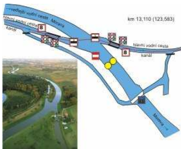
Obr.32 Shybka umožňující převod vody přes jez Vnorovy. (upraveno podle: www.batuvkanal.info )
