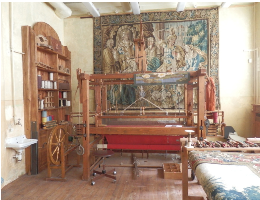
Obr. 10: Soukenický stav pro tvorbu ubrusů, prostírání, ale i oděvů, v pozadí visí historická tapiserie (foto Jana Burešová, 20. 4. 2012)
