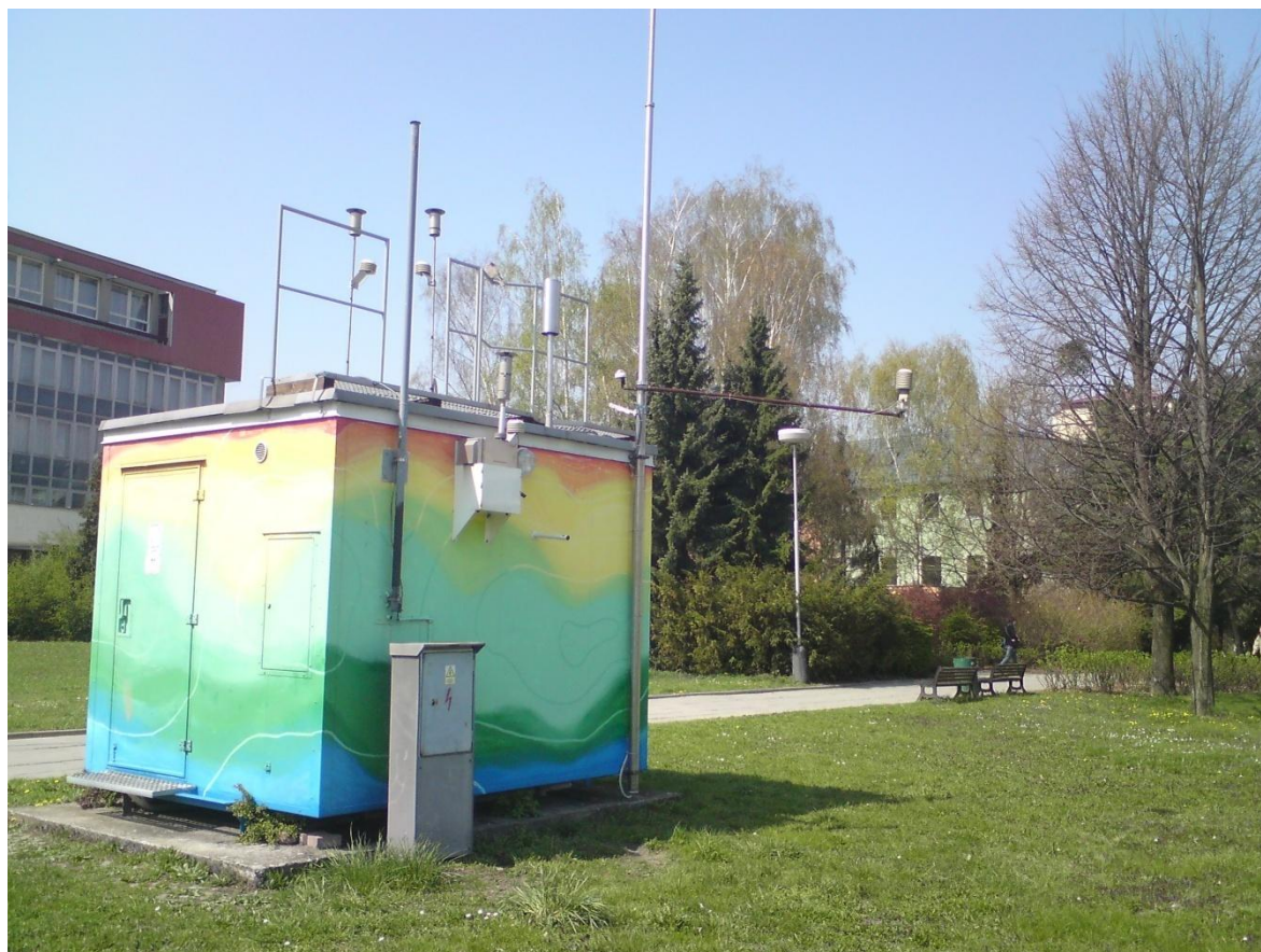
Obr. 6.1 Automatizovaná imisiční stanice ... (Foto: T. Bukovcová, 12. 3. 2012)
