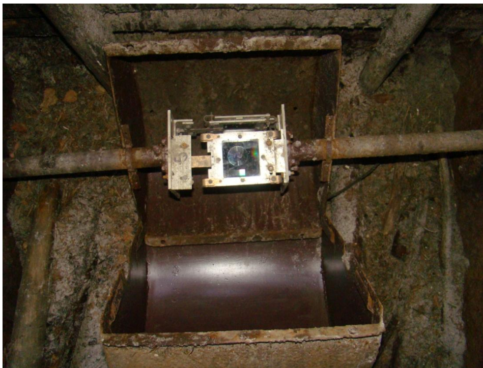
Obr. 6: Terčové měřidlo TM-71 ve Sluji Českých bratří (Autor: I. Vajsarová)
