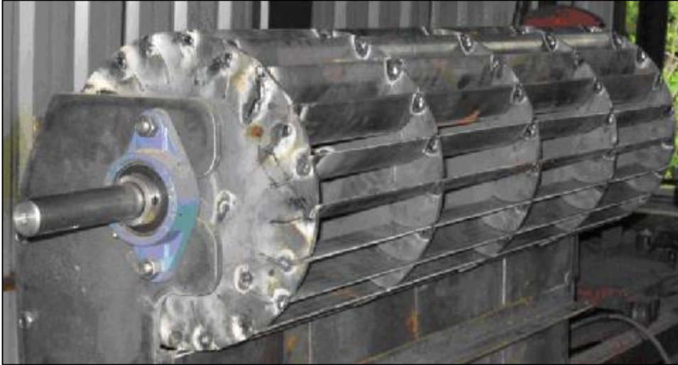
Obr. 5: Bankiho turbína (Zdroj: vodni-elektrany.cz)
