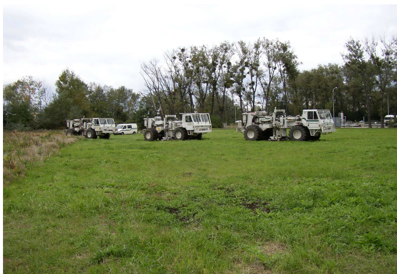
Obr. č.13 : Polní seismické měření technikou Vibroseiz v Poštorné u Břeclavi v roce 2007 pro společnost ČNS s.r.o. (foto ing.Důbrava)
