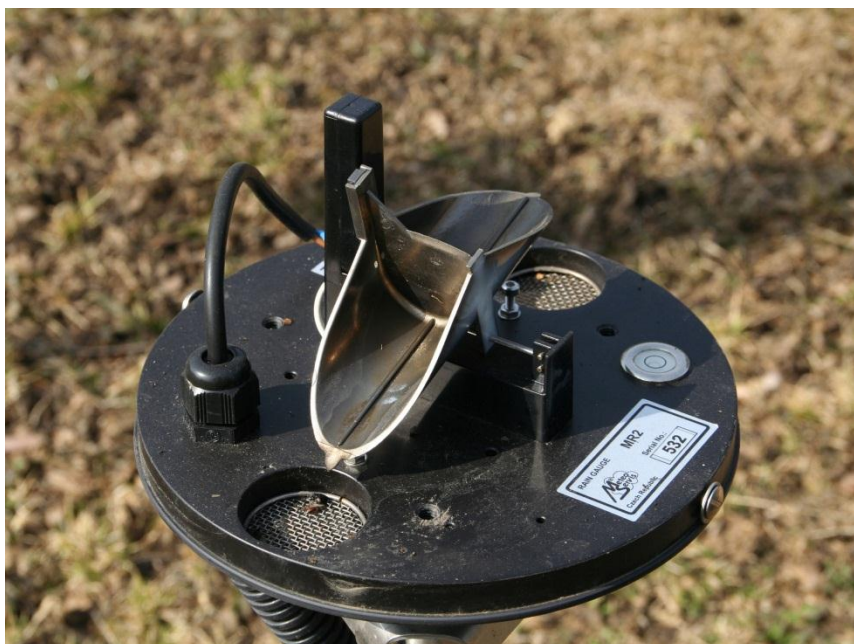
Obr. 1 Člunkový mechanismus srážkoměru Fiedler SR02
