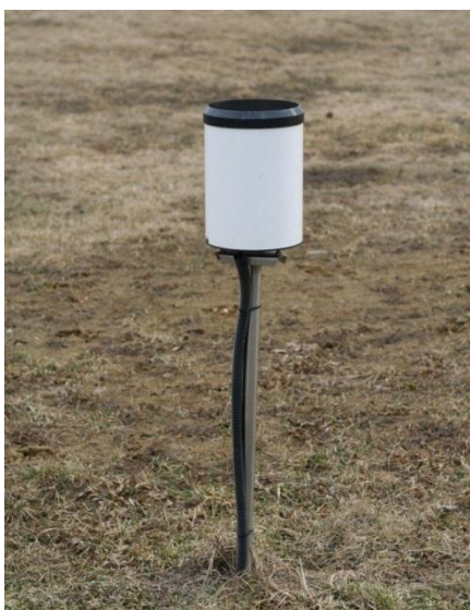
Obr. 5 Srážkoměr Fiedler SR02 (M. Kulczycki, 11. 3. 2011)
