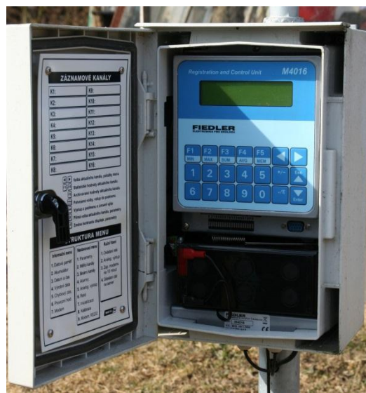
Obr. 6 Univerzální řídicí jednotka M4016 (M. Kulczycki, 12. 3. 2011)
