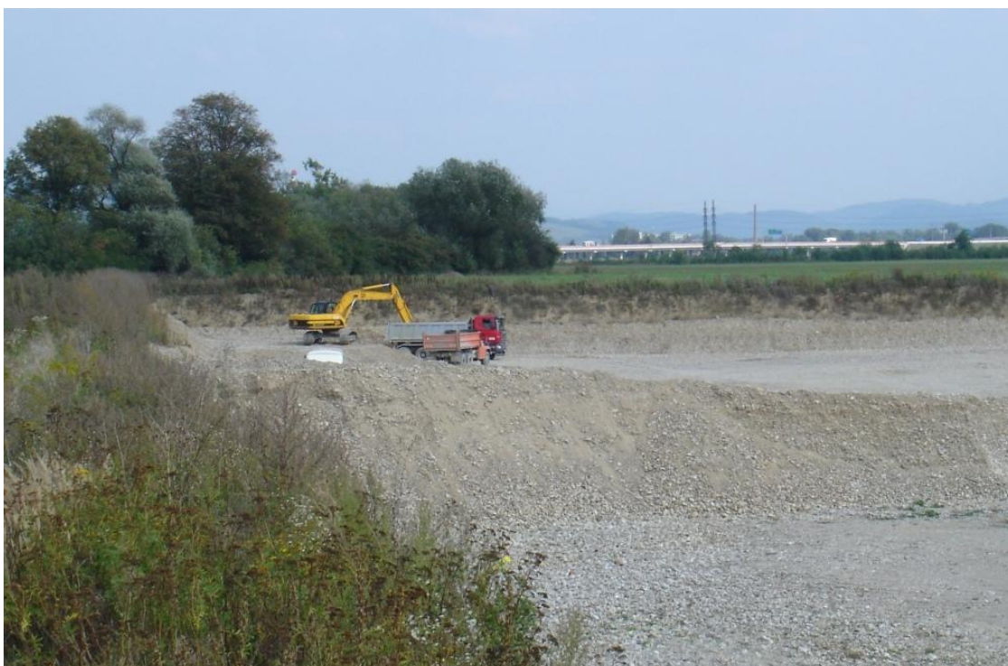
Obr.12.: Ťažba štrkopieskov suchým spôsobom, Malá Bytča (Foto: M. Pramuková, 16.9.2009)
