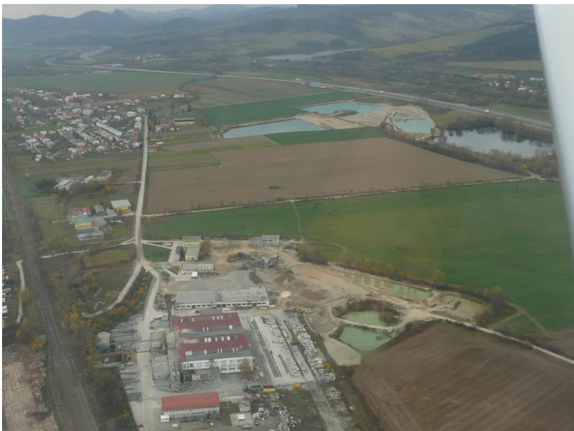
Obr.10.: V pozadí priestory ťažby štrkopieskov Malá Bytča, v popredí odkaliská po úprave štrkopieskov praním a triedenie podľa veľkosti zŕn (Foto: P. Studený, 1.11.2008)
