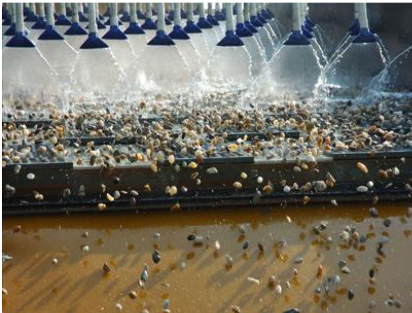
Obr.5.: Úprava štrkopieskov praním (Zdroj: BRA-VUR, http://www.bravur.sk/index.htm )
