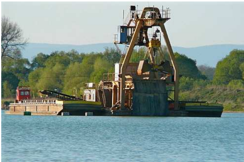
Příloha 5.: Těžba na DP Mohelnice I., ložisko Mohelnice III. - Třeština - čelistový bagr
