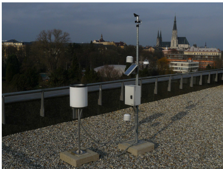
Obr. 77: Automatická meteorologická stanice MESSO Olomouc Envelopa
